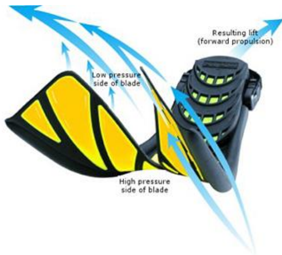
Abbildung 2: Split-Fin Funktionsweise vereinfacht
